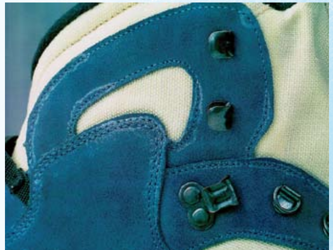
Auswirkungen eines nicht ordnungsgemäß hydrophobierten Nähzwirnes
