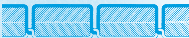
Doppelsteppstich mit einer für Ziernähte auf Leder typischen Fadenverteilung
